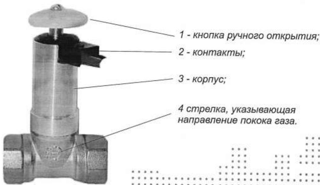
Вид климатического исполнения клапанов УХЛ 4.2 по ГОСТ 15150-69, но в расширенном диапазоне температуры окружающей среды от 0 до 50 ° С. Рабочая среда – природный газ ГОСТ 5542-87, паровая фаза газа (СУГ) ГОСТ 20448-90 и воздух ГОСТ 17433-80. Температура рабочей среды при эксплуатации от 0 до 50 ° С.
